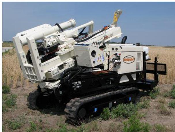
图 6-3 Geoprobe 7822DT 钻机示意图
