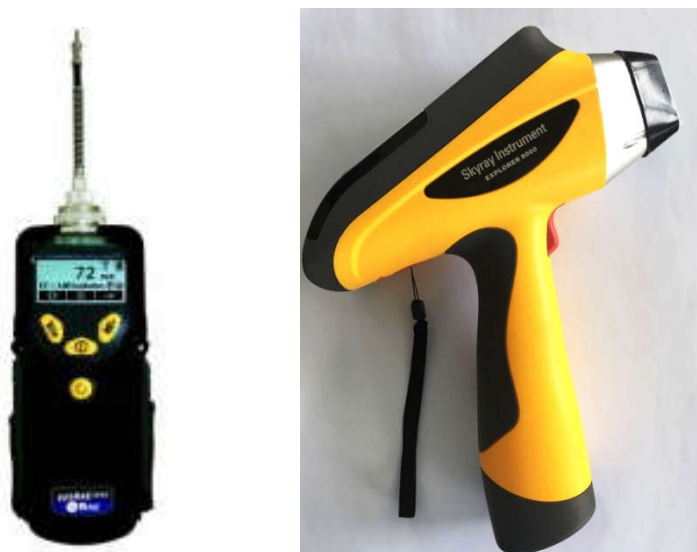
图 4-6 手持式 PID 及检测仪与 XRF 检测仪
