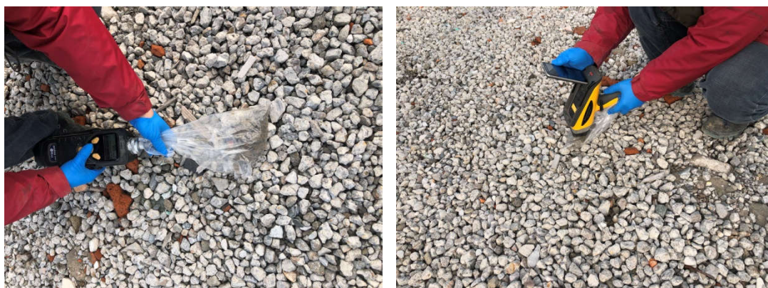
图 4-6 土壤样品 PID 检测（左）和 XRF 检测（右）
