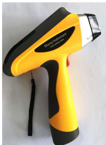
图 4-13 手持式 PID 及检测仪与 XRF 检测仪
