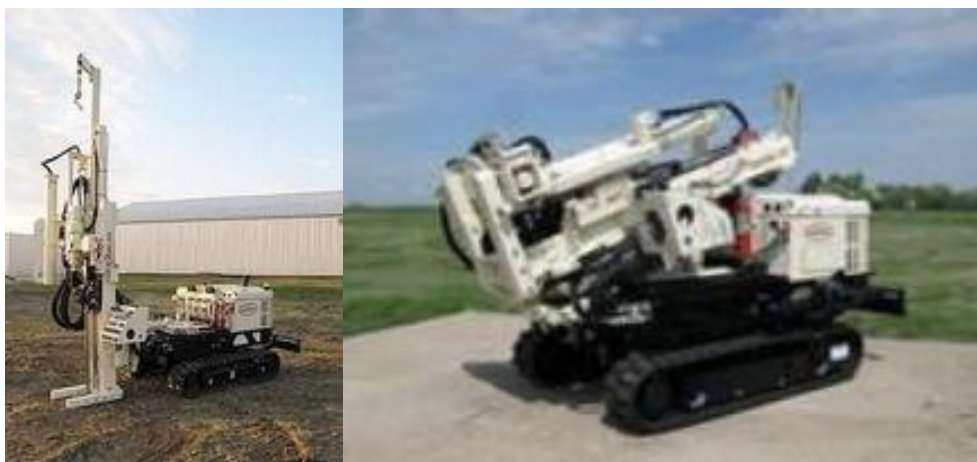
图 6-2 Geoprobe 7822DT 钻机示意图
