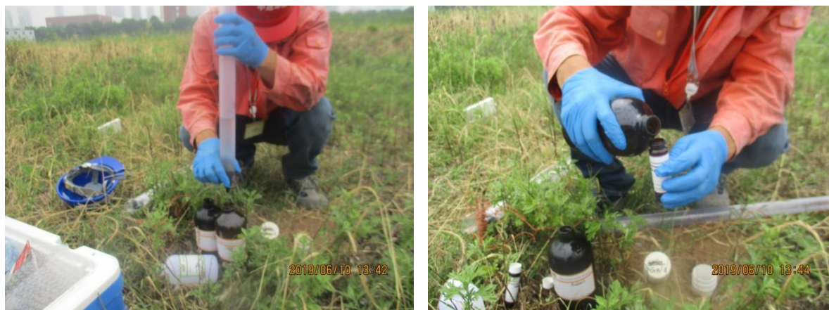
图 5-11 地下水样品现场采集照片
