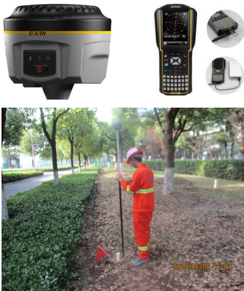
图 5-1 南方（South）“银河 1” RTK 测量系统及现场操作图
