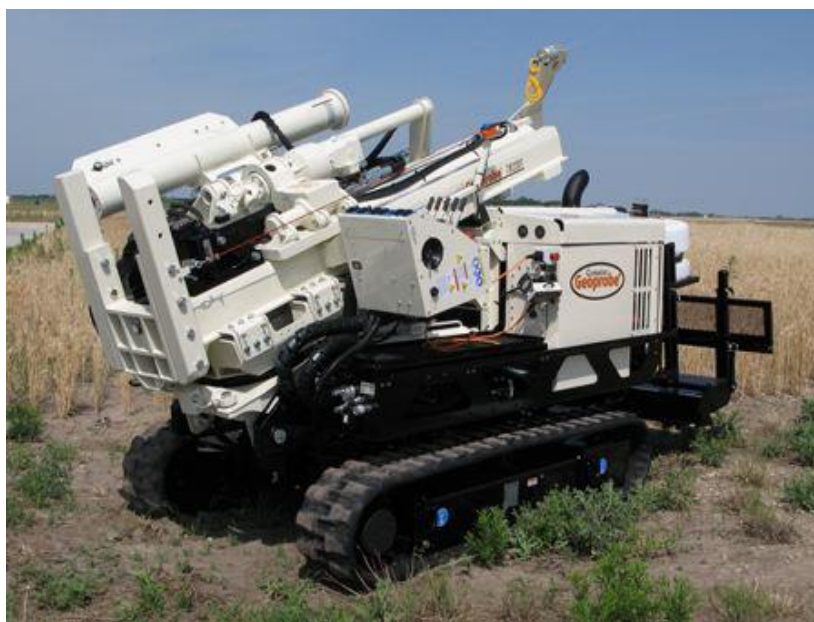
图 5-2 Geoprobe 7822DT 钻机示意图
